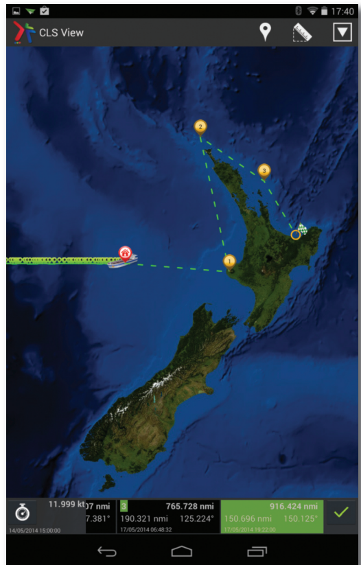
CLS View fournit un temps d'arrivée estimé (ETA) du mobile compte tenu de la vitesse et de la destination finale.
