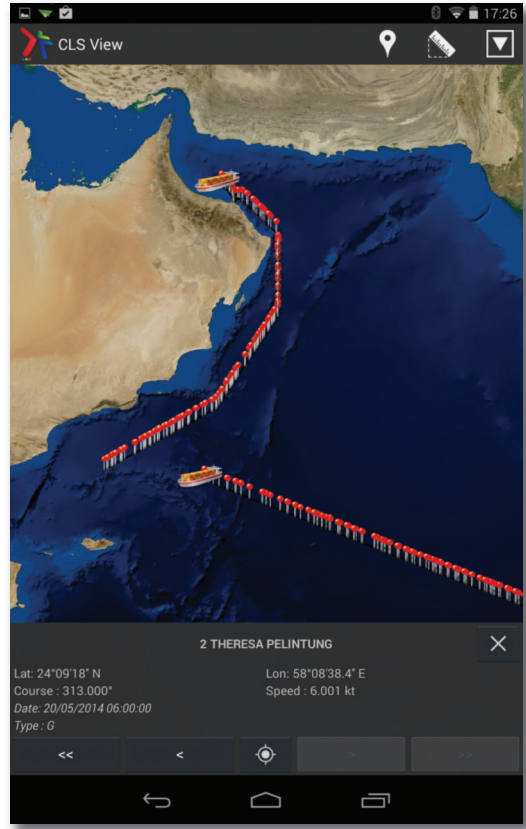
CLS View fournit des données de suivi mobile avec différents fonds de carte (ici Google Earth). Données de vision de 100 mobiles maximum et jusqu'à 2500 positions.
